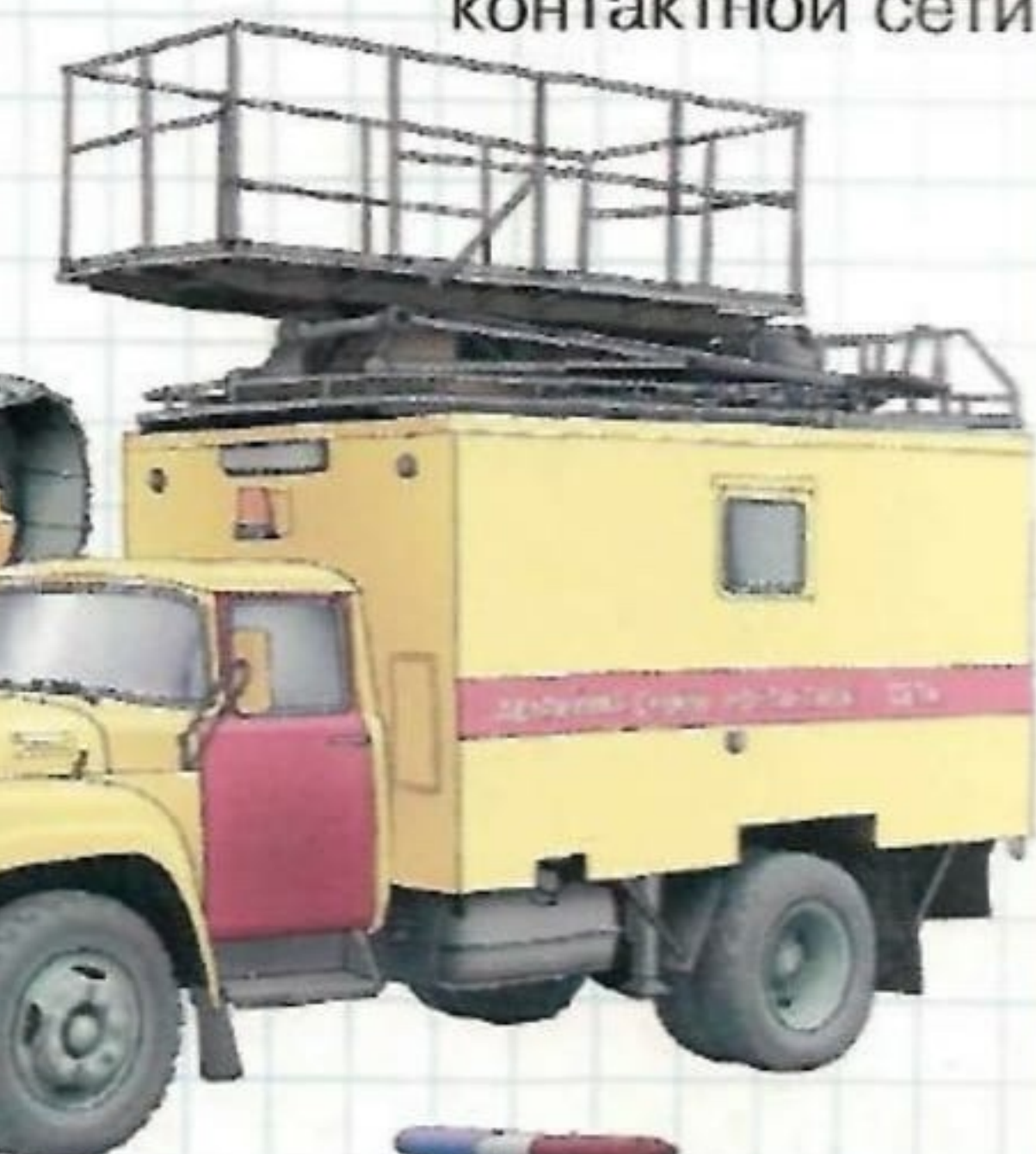
Аварийная машина службы контактной сети
